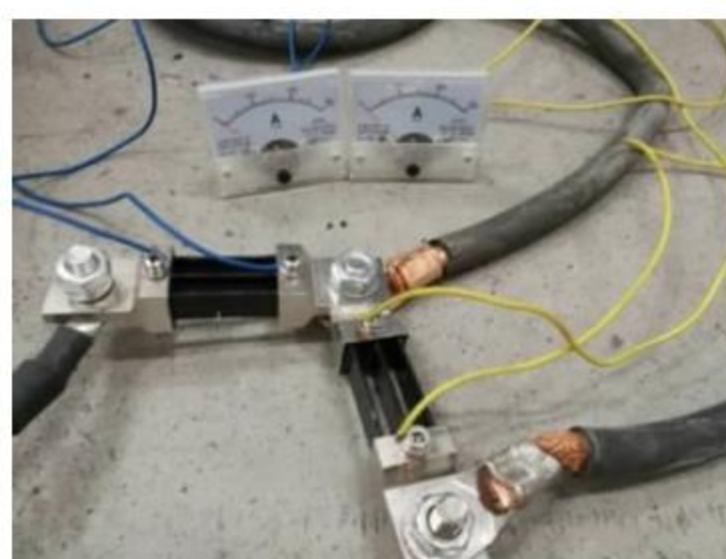
图 3 电流采集部分 Fig.3 The current acquisition part
