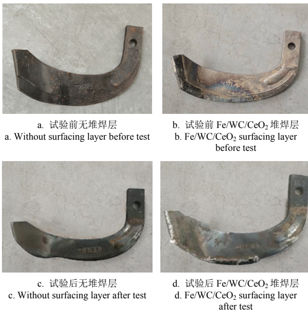
图12 田间试验前后的刀具磨损形貌
