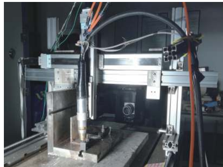
图 5 焊接试验装置
