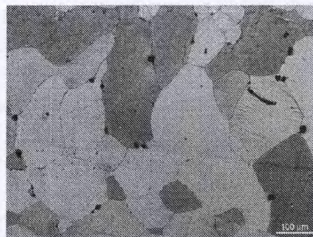
(f) 第4组焊缝与 HTHAZ 形貌
