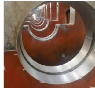
图1 主轴承孔检测超差
