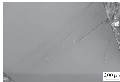
(a) 试样垂直于焊接方向SEM裂纹
