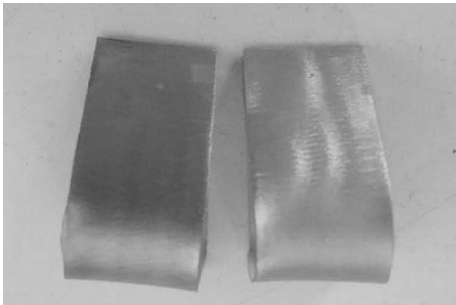
图 8 晶间腐蚀(E 法)检测试样
