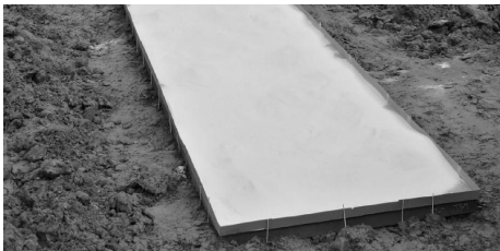
图3 装药后的 SA533GrBCL2 - 304L 金属复合板
