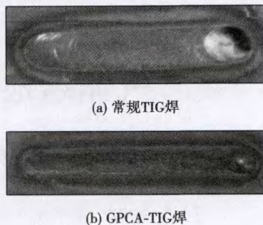
图 2 焊缝表面形貌
