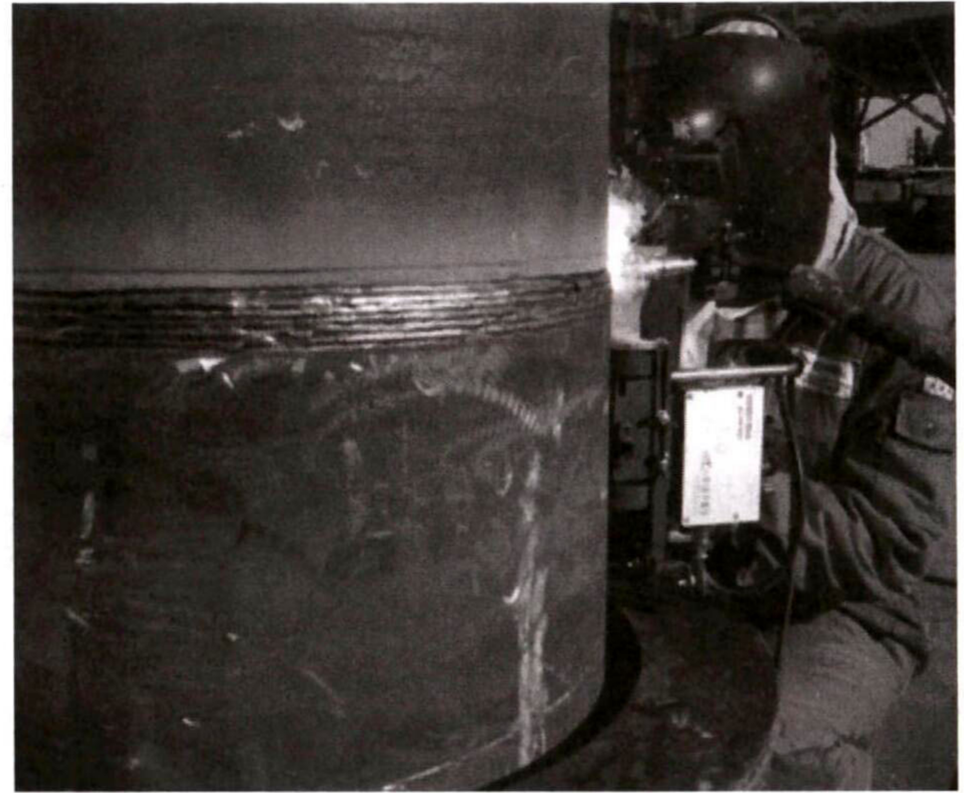
图3 焊接小车作业
