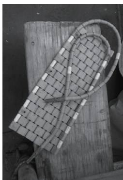
图 4 热处理设备使用的陶瓷加热片
