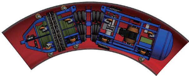
图7 5D热煨弯管中柔性内对口器状态
