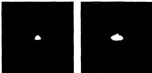
(a) 无活性剂 (b) \text{ZnF}_2 图 6 无活性剂时和涂敷 \text{ZnF}_2 时的电弧形貌 Fig.6 Arc appearances without flux and with \text{ZnF}_2
