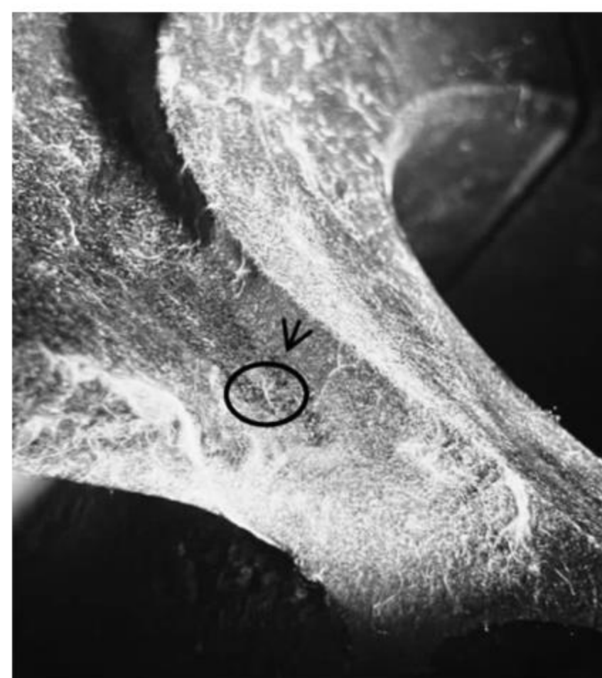
图 7 磁粉探伤结果
