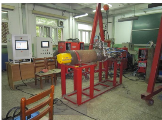
图 6 海底管道铺设焊接机器人系统
