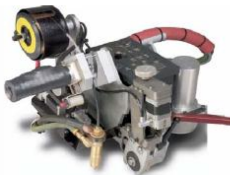
图 1 单丝单炬管道铺设焊接机器人
