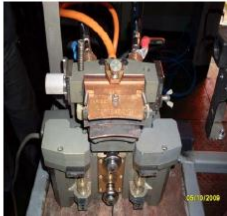
图2 双炬铺管焊接机器人
