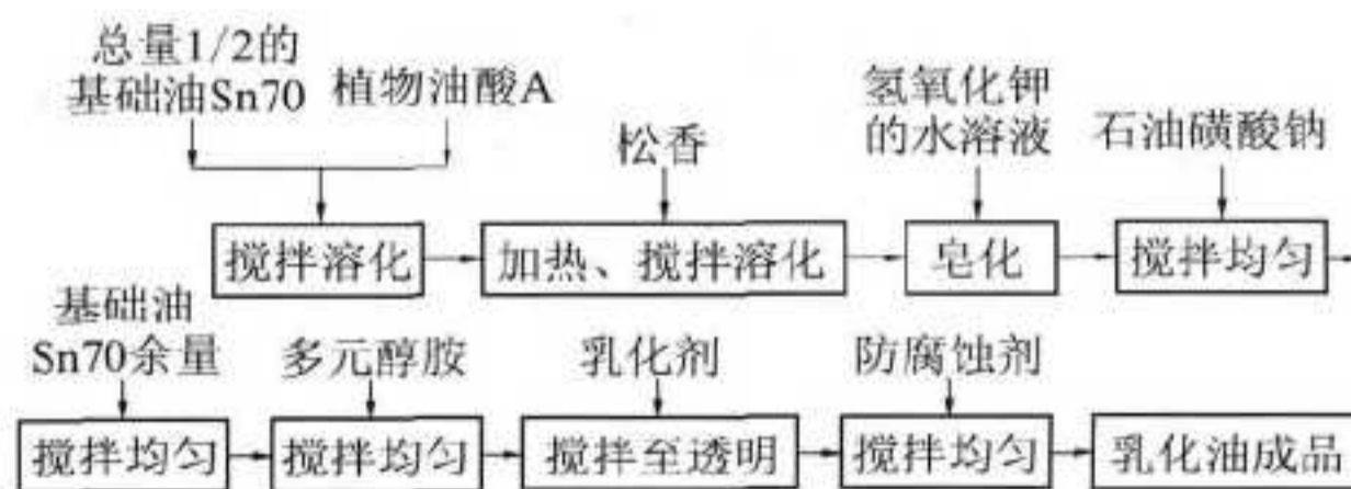
图 1 以松香钾皂做乳化剂制备乳化油的生产工艺
