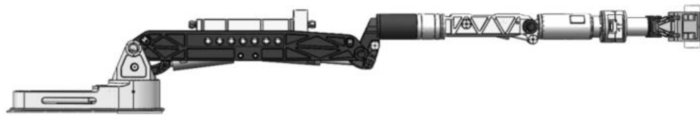
图2 六自由度液压机械臂水平全展开状态
