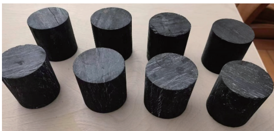
图 1 动态冲击试验煤样
