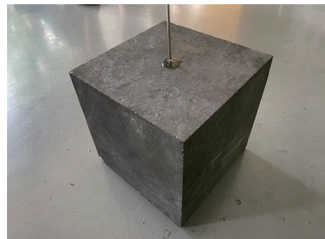
图 2 密封后煤样试件
