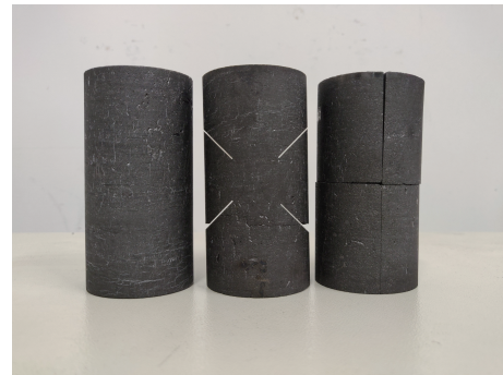
图 3 三轴压缩及渗流试验煤样
