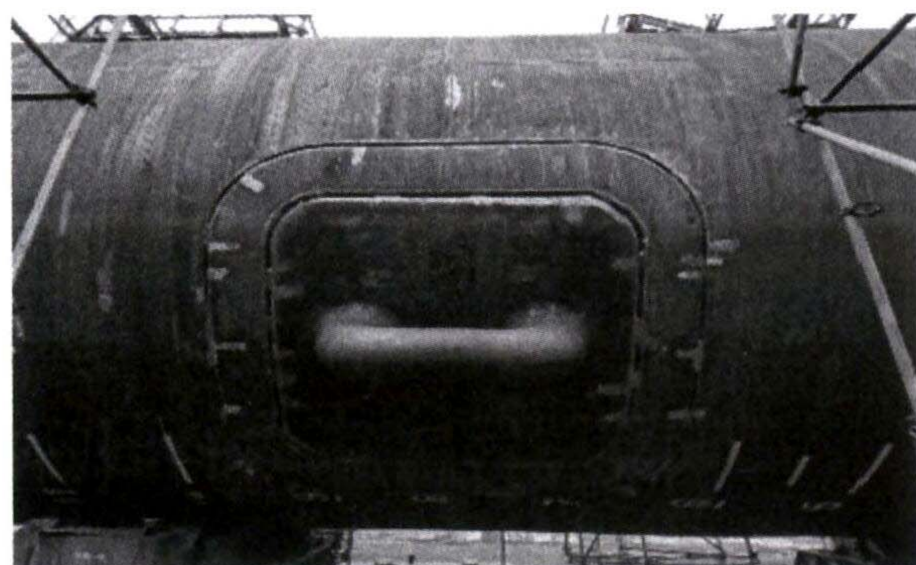
图2 铸件系泊锚耳在筒体上的安装
