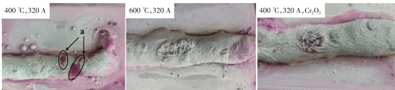
图 4 堆焊层渗透检测
