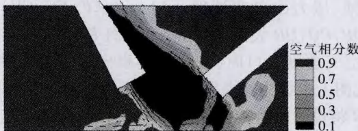
图 5 电弧保护气体流速为 3 m/s 时流场的计算结果( v_{\text{laser}}=3\text{ m/s} )
