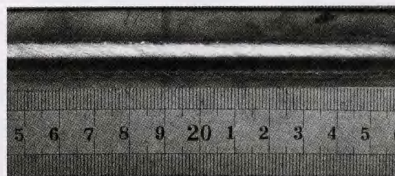
(a) 焊缝正面成形
