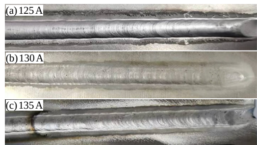
图 1 不同焊接电流下 7075-T651 铝板 TIG 焊后接头的宏观形貌
