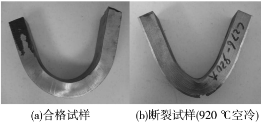
图 6 外弯曲试样外观
