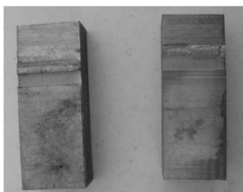
图 4 600 °C (左) 和 720 °C (右) 退火试样剪切后外观
