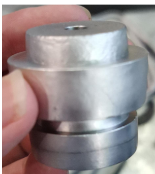
图3 线圈骨架零件焊后实物图
