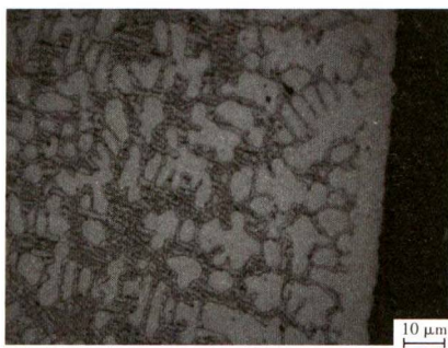
图3 B添加量为2%时堆焊层横截面的组织形貌
