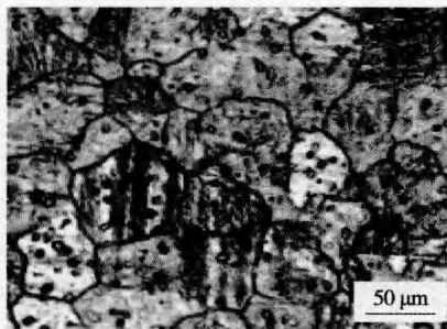
图 5 无活性剂无磁场时焊缝显微组织
