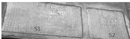
图 2 试件堆焊层焊道外观
