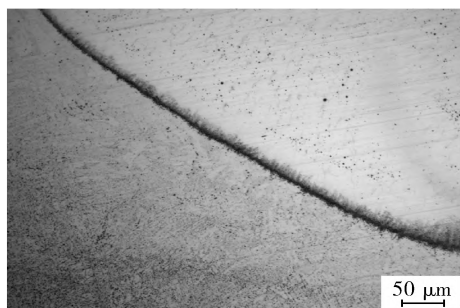
(a) 堆焊层及母材熔合线
