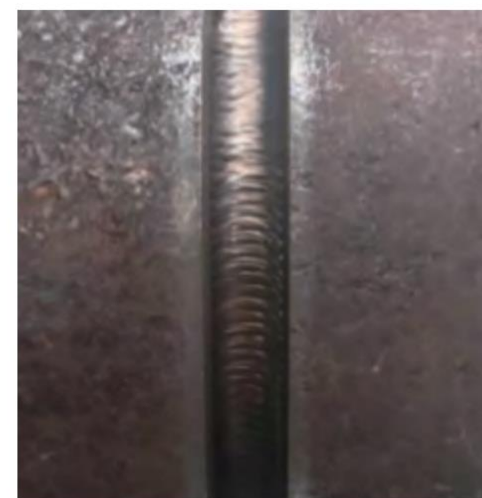
图10 某一层焊道形貌
