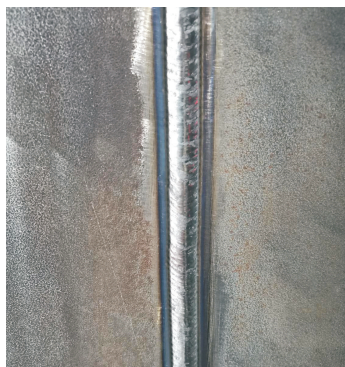
图4 窄坡口智能热丝TIG焊焊缝成形
