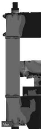
图 8 工作状态下压机应力状态
