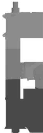
图 7 工作状态下压机整体变形
