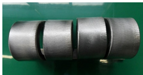
图10 不带过渡层弯曲试样效果图
