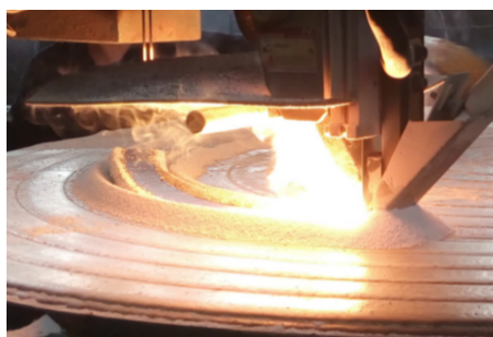
图1 带极电渣堆焊操作图
