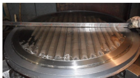
图5 直焊道堆焊管板
