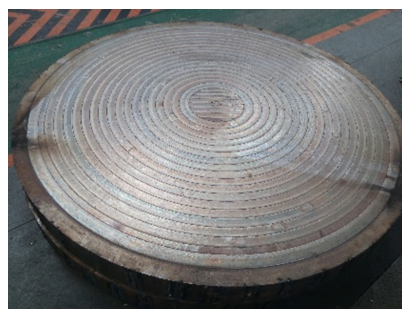
图6 环焊道堆焊管板
