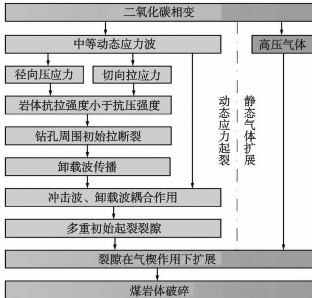
图 5 二氧化碳相变致裂应力 - 气体协同作用机理
