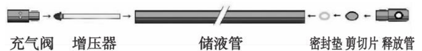
图 4 二氧化碳气相压裂装置结构示意图
