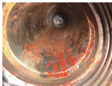
图 1 缸筒内壁腐蚀图
