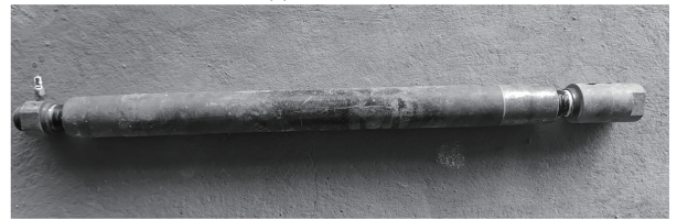
图 1 致裂管结构示意图及实物
