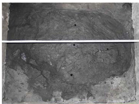
图3 混凝土固定的原煤试件
