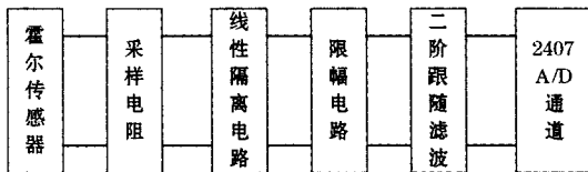
图5 电流检测与预处理
