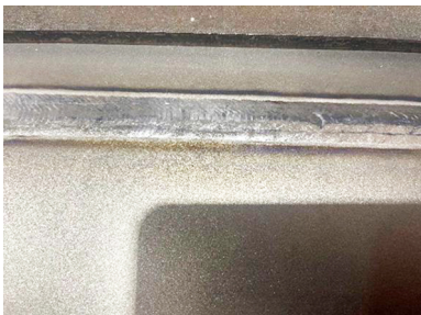
图5 对接焊缝表面宏观形貌 Fig. 5 Macro morphology of butt weld surface
