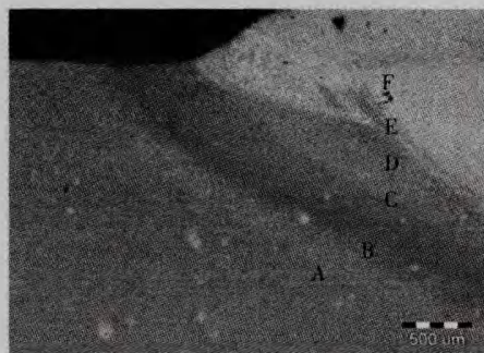
图 3 软铁弹带堆焊接头熔合线
