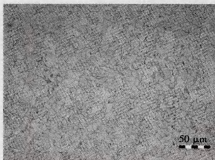
(a) 基体为20#钢的焊缝区
