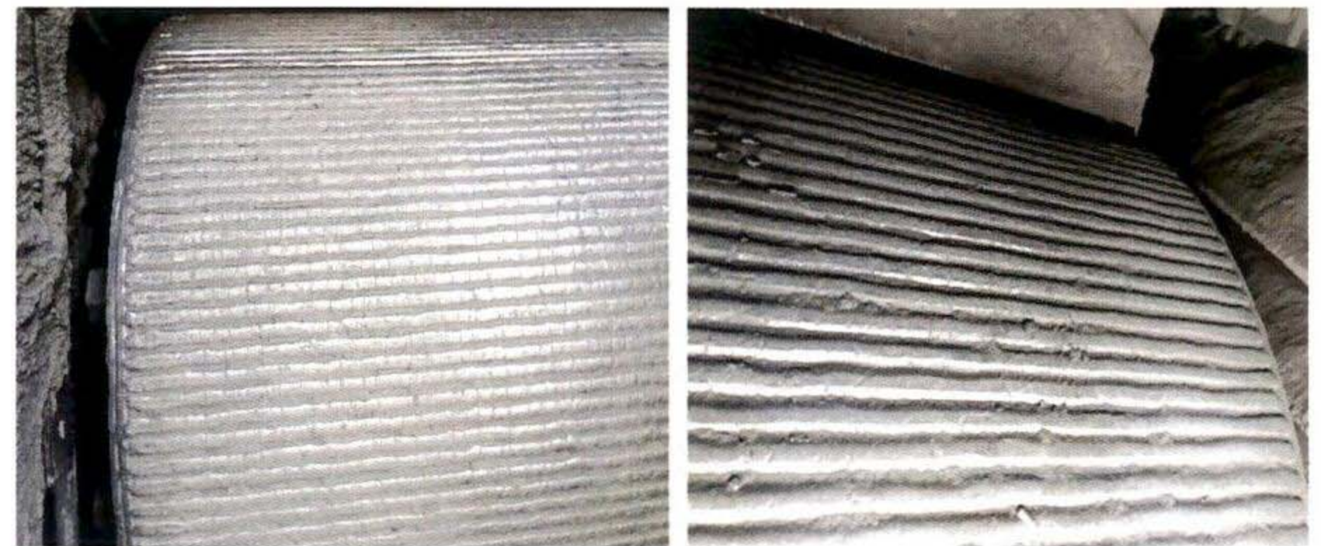
未打磨前的动辊辊面 打磨后的动辊辊面
