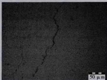
图 3 使用 Cu-4Ti 合金焊材时焊缝中的裂纹
