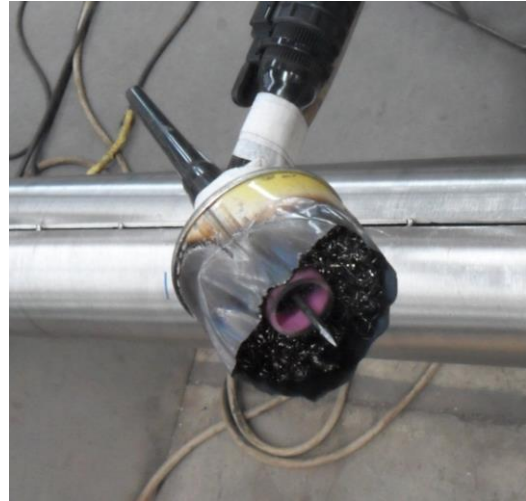
图 2 焊枪喷嘴自制简易大保护罩
