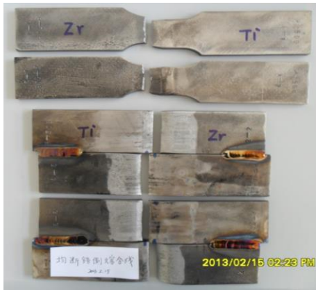
图 4 拉伸试样和弯曲试样
