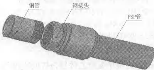
图5 钢塑过渡接头连接示意
