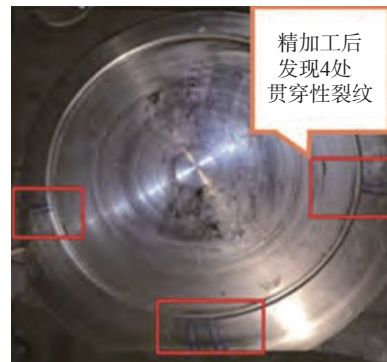
图 5 闸板精加工后四处贯穿性裂纹
