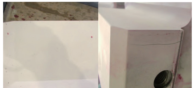
图 11 堆焊件机加工后的液体渗透检验显示
