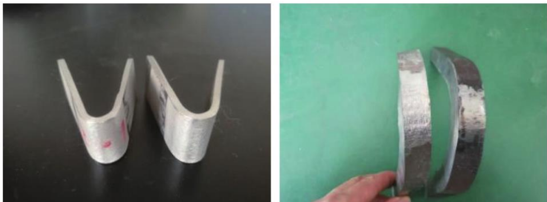
图8 冷弯试件破坏模式 Fig. 8 Failure modes of bending specimens
