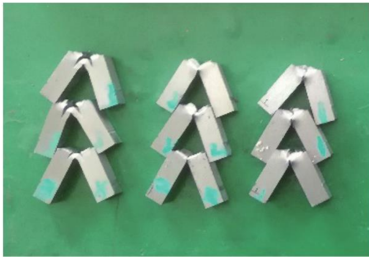
图9 夏比冲击试件破坏模式
