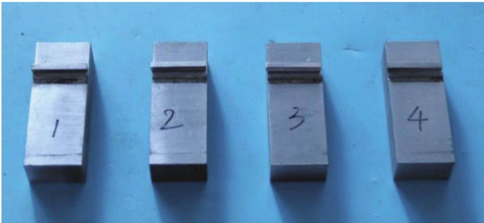
图10 剪切试件破坏模式
