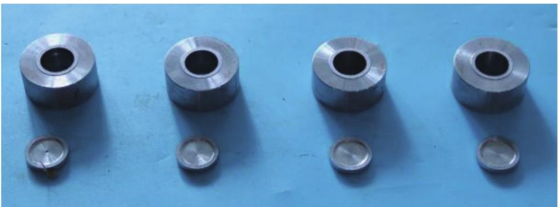
图11 粘结试件破坏模式
