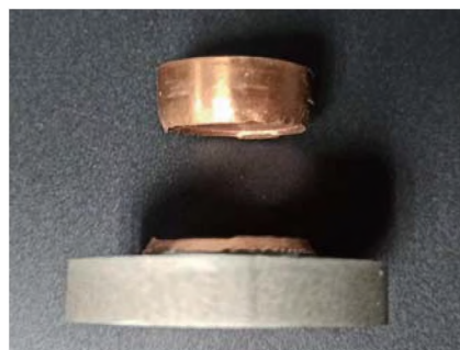
图 6 结合强度检测试样断后宏观形貌
