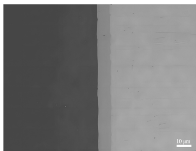
图3 铜基体表面镀镍金相微观形貌
