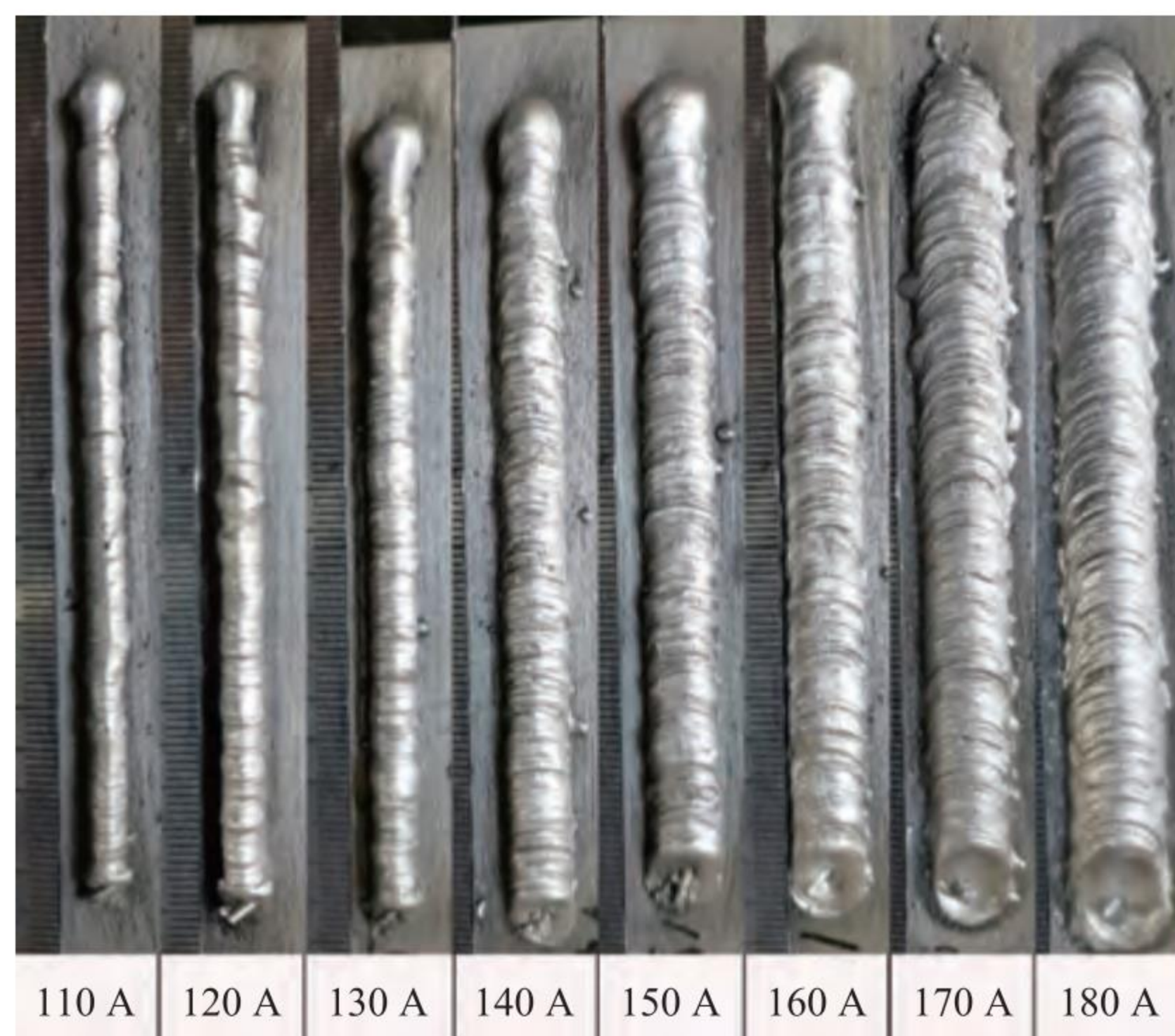
图3 各个电流下单层单道熔覆层的宏观形貌
