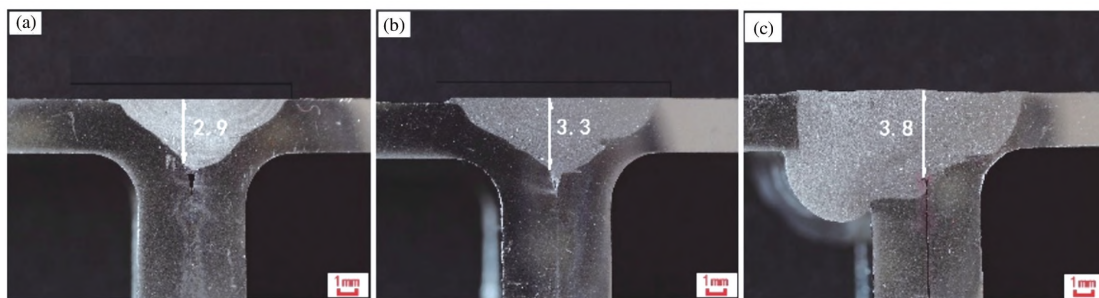
(a) 焊接电流 130A; (b) 焊接电流 140A; (c) 焊接电流 150A
