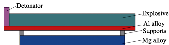
图 3 铝镁合金板爆炸焊接示意图 [11]
