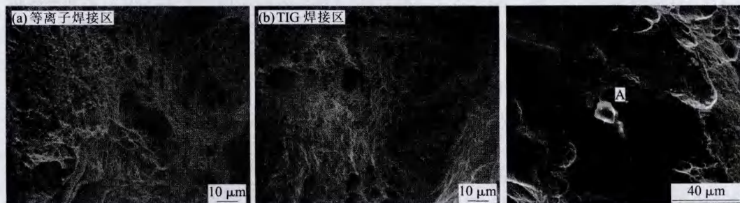
图 4 拉伸断口微观形貌
